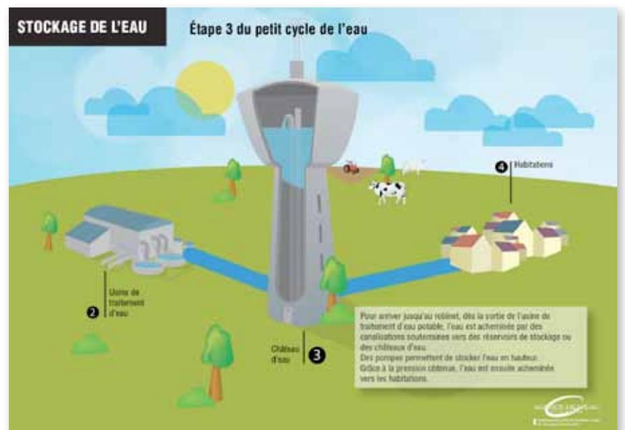
**3. le stockage :** une fois prélevée et traitée, l'eau est stockée dans un réservoir enterré ou un château d'eau.
