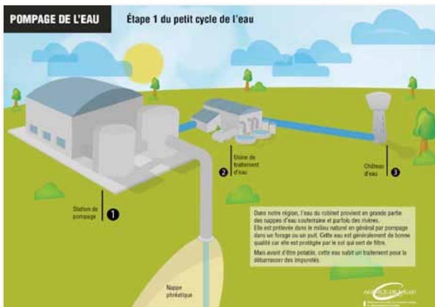
**1. le prélèvement :** notre eau est issue des eaux souterraines qui proviennent de l'infiltration des eaux de pluie dans une couche de terrain perméable.
